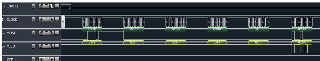
从时序图。看出这种读方式下, MOSI 和 MISO 都参与了读数据的传输。所以在这种模式下, 一个 SPI 可以读取两个字节。
