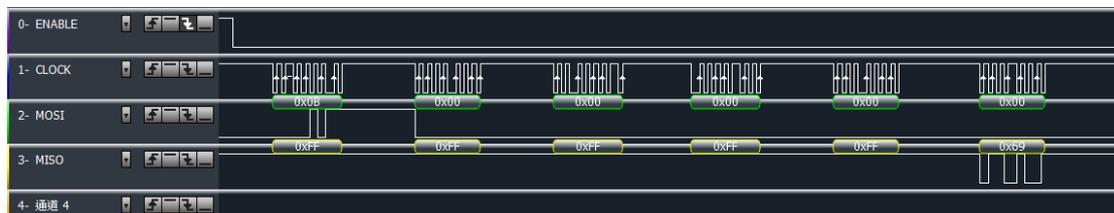
快速读方式, 要等待 5 个 SPI 周期后, 才开始读取有效信息。而普通读模式下, 只需等待 4 个 SPI 周期后, 就可以读取有效信息了。
